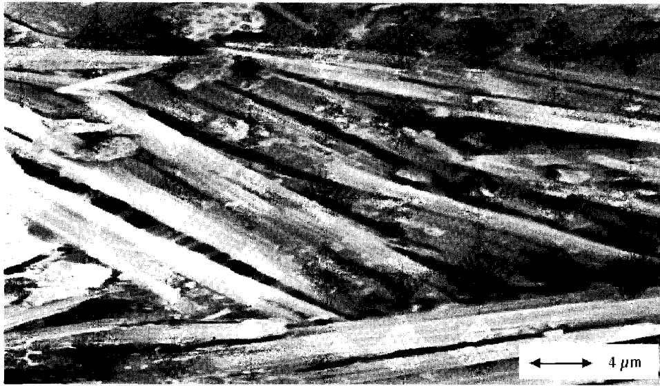
Fig. 8 - Aiguilles aplaties de thaumasite \times 2\ 500 .
