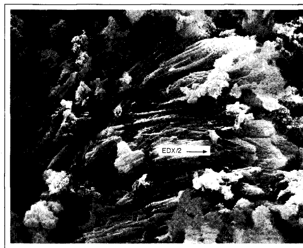
Fig. 6 - Ettringite secondaire dite comprimée.
