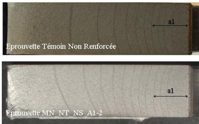
Fig. 2. Exemple de suivi de fissure sur éprouvette avec et sans renforcement composite
