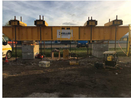
Figure 3. Dispositif de chargement du pieu
