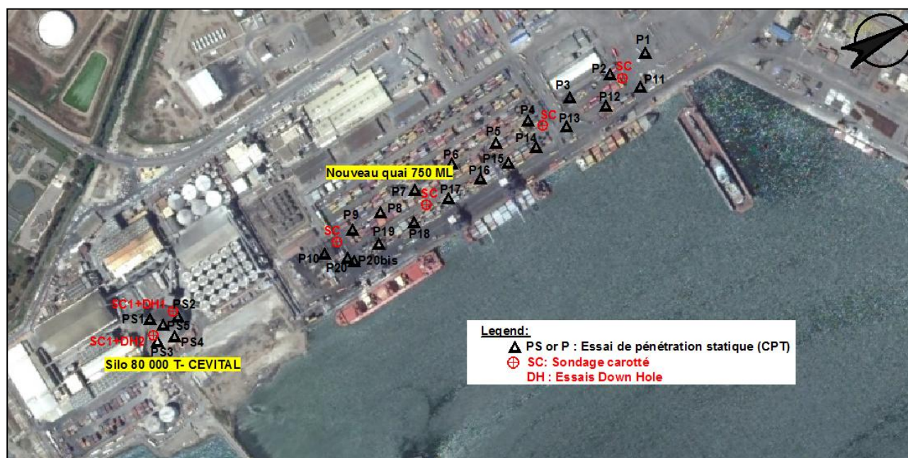
Figure 3. Implantation des tests géotechniques et géophysiques dans la nouvelle zone portuaire de Bejaia sur Google Earth.
