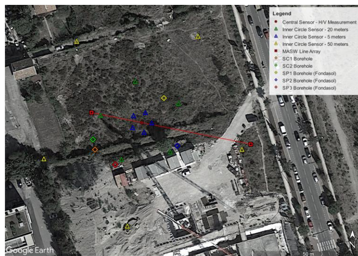
Figure 5. Position des stations du réseau sismique (triangles) et du profile MASW. Les forages SC1 et SC2 sont représentés par les diamants orange et vert. Les forages pressiométriques SP1, SP2 et SP3 sont visualisés par les diamants jaune, bleu et rouge.
