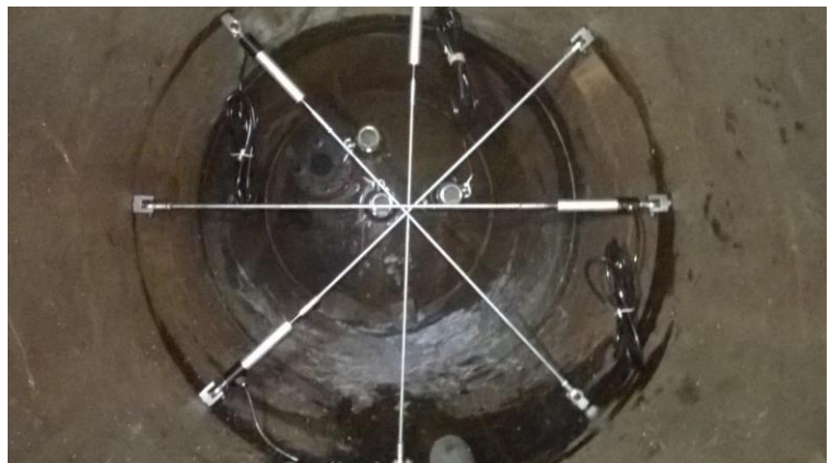
Figure 3 – Position des capteurs numérotés au sein d'une section instrumentée d'alvéole et photo correspondante.
