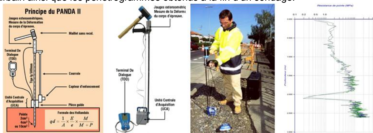
Figure 1. (a) Principe du pénétromètre dynamique Panda 2, (b) vue de l'ensemble, (c) Essai réalisé sur site et (d) Pénétrogrammes obtenus et visualisables sur l'appareil (Benz, 2009)
