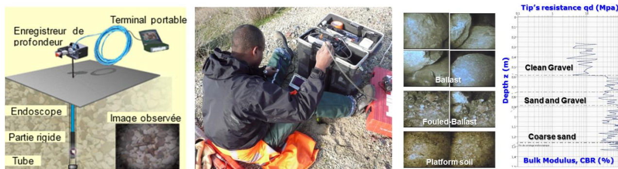
Figure 2. (a) Principe de l'essai géoendoscopique, (b) essais sur site, (c) exemple d'images obtenues en profondeur et (d) couplage du pénétrogramme Panda® et des caractéristiques issus de l'analyse d'images géoendoscopiques : Pandoscope®
