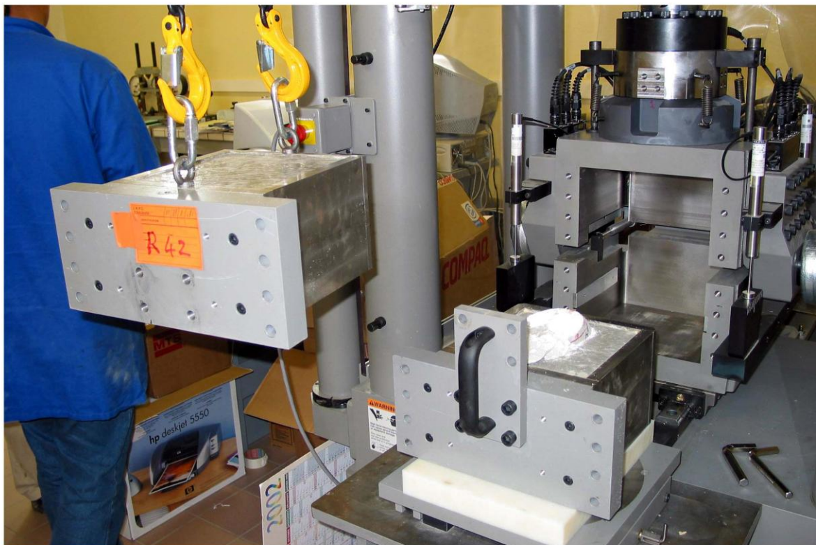
Figure 2 : essai de cisaillement sur discontinuité calcaire
