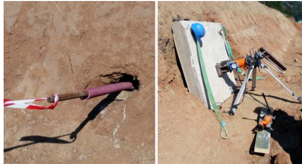
Figure 3 : essai de traction de boulon
