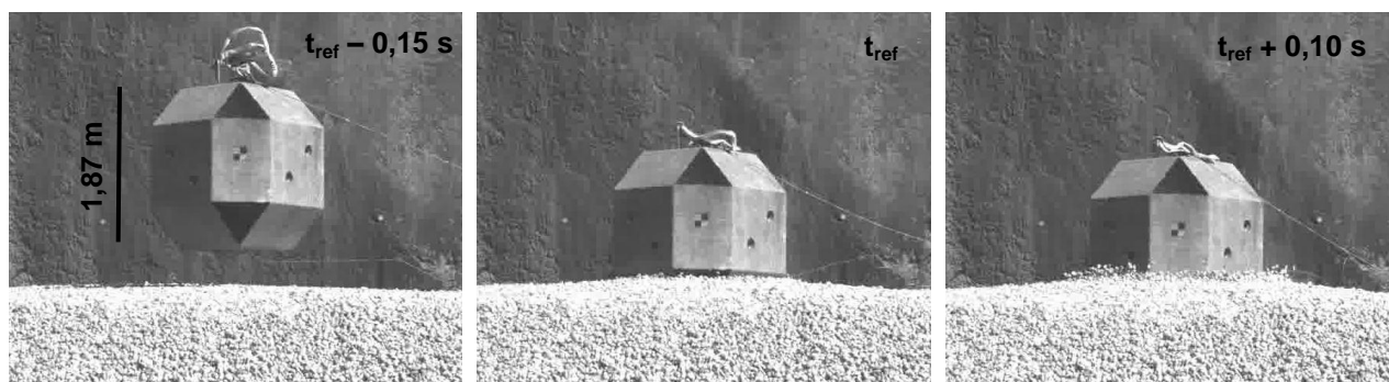
Figure 3. Images de l'impact à 300 kJ sur la couche support seule, issues d'une caméra rapide
