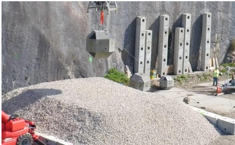
Figure 1. Dispositif d'essai avant lâcher sur couche support
