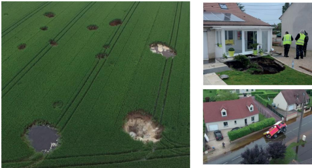
Figure 1. Cas d'effondrements de cavités souterraines dans le Val d'Orléans (secteur Gidy) après les inondations de juin 2016.
