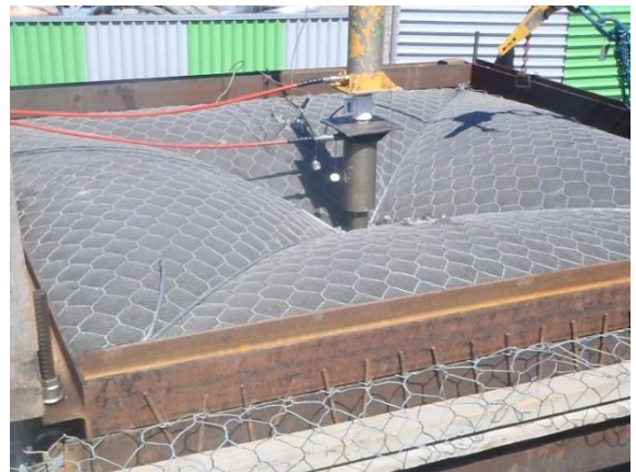
Figure n°4 : Vue en coupe du banc d'essai et essai de poinçonnement en cours
