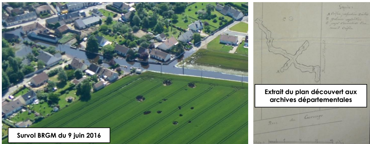
Figure 5 : Gidy – Multiples mouvements liés à la ruine d'une carrière souterraine
