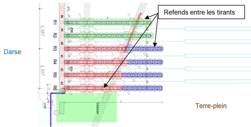
Figure 8. Renforcement par panneaux de jet grouting de la zone décomprimée
