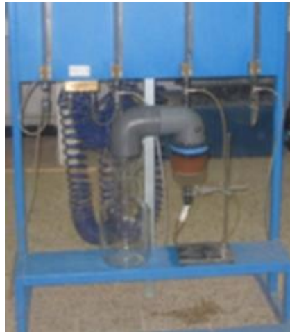
Figure 2: Dispositif expérimental pour le traitement hydraulique du sable au silicate de soude
