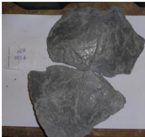
Figure 4. Discontinuité ouverte dans les schistes graphiteux Plan S1 d'aspect lustré, site 3).
