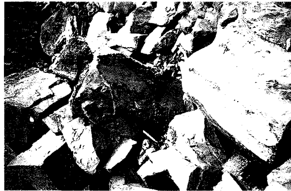
Fig. 2 - Blocs de calcaires incluant des niveaux à carboniaux (lentilles noirâtres).
