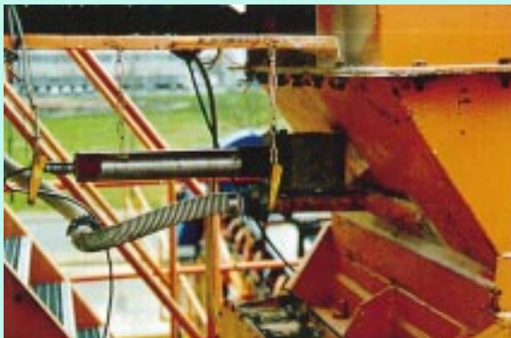
Fig. A - Détecteur d'entrée (canalisation d'eau d'ajout).
