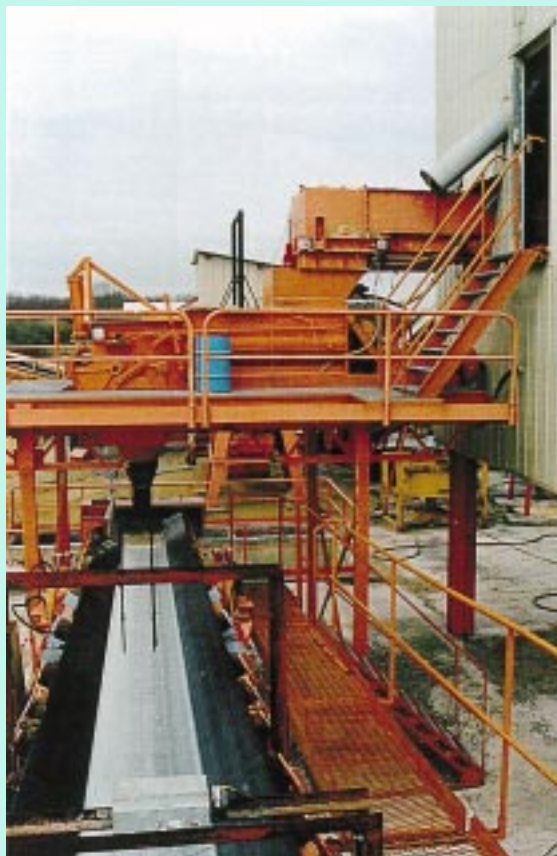
Fig. B - Comptage des particules marquées sur le tapis échantillonneur en sortie de malaxeur.
