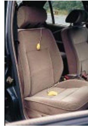
Fig. 7 - Essais du LCPC avec la R21 ; accéléromètres à l'interface homme/siège.
