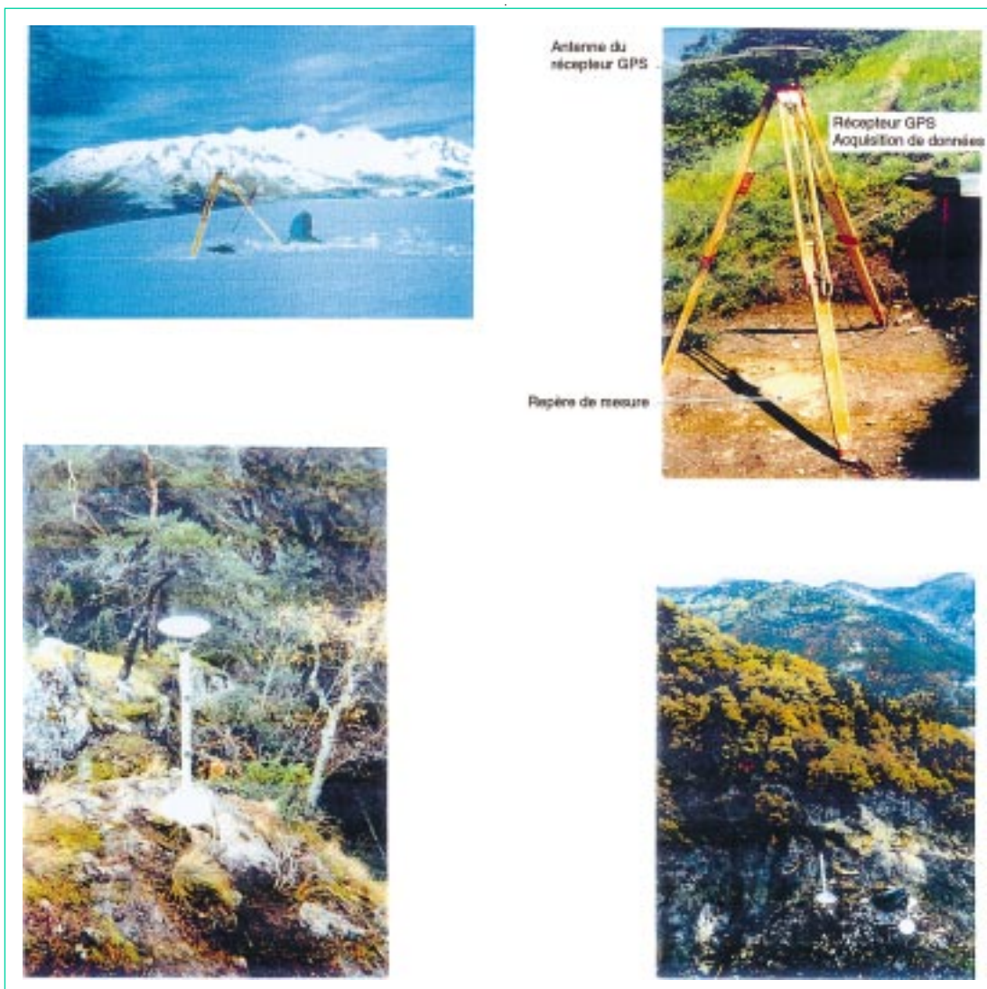
Fig. 1 - Exemples d'instrumentation pour le suivi par méthode GPS.
