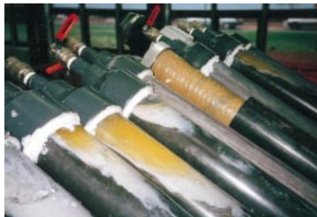
Fig. 6 - Accumulation de produits délétères en partie haute des tubes.
