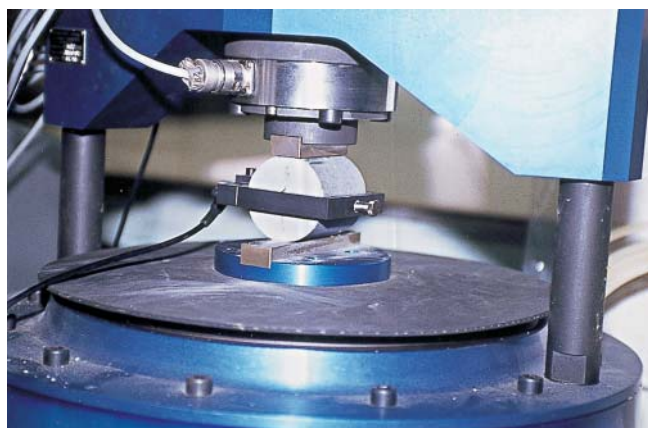
Fig. 5 - Essai R_t , E sur éprouvettes 5 x 5.
