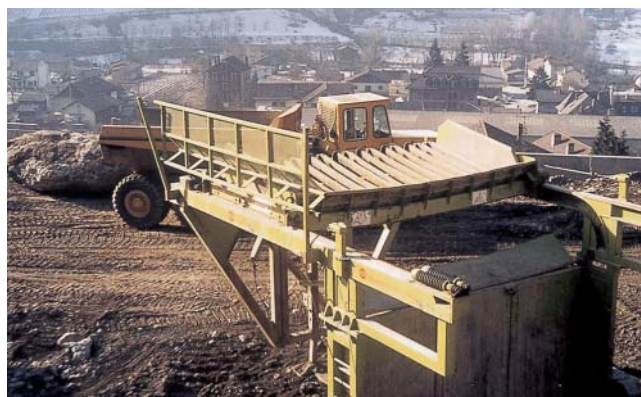
Fig. 7 - Crible à barreaux « Simbagrid 3900 » (écartement de 110 millimètres).
