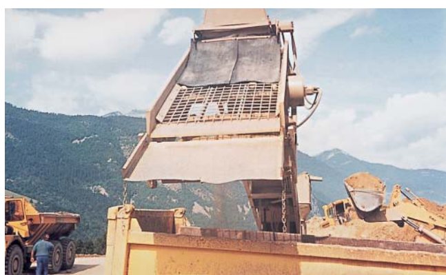
Fig. 6 - Tamis vibrant (mailles de 90 millimètres).
