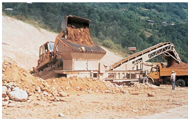
Fig. 5 - Crible à deux niveaux (barreaux + tamis □).
