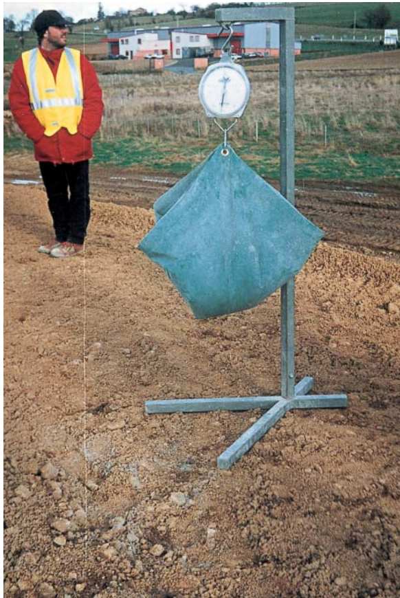
Fig. 5 - Pesée sur site.
