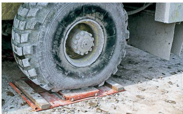
Fig. 7 - Pesée d'épandeur au moyen de plates-formes de pesée « Captels ».
