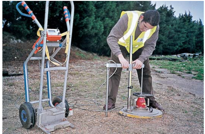
Fig. 6 - Mesure de profil de densité à la double sonde.
