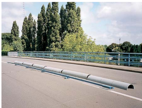
Fig. 4 - Une chaîne de 4 courburemètres du LRPC de Lille (CLRL), en place, de jour, sur un autre ouvrage.
