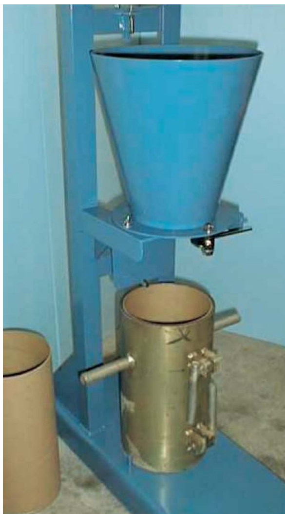
Fig. 2 - Adaptation de l'appareil de Glanville pour la fabrication d'éprouvettes \varnothing 16 \times 32 cm.
