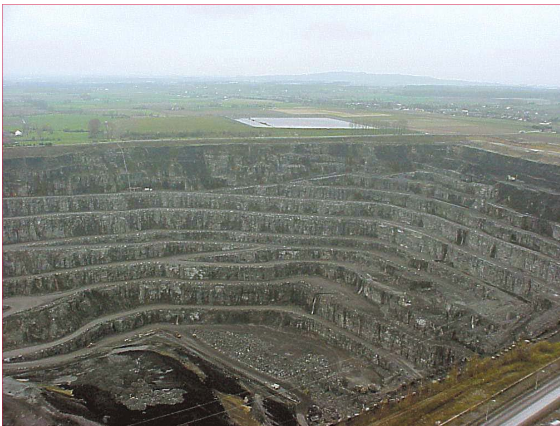
Fig. 1 - Importance des fronts de taille dans les gisements qui exploitent les calcaires d'âge primaire du Tournaisis. Entre la surface topographique et la base du gisement, on peut compter dix banquettes d'une hauteur moyenne de 20 mètres.
