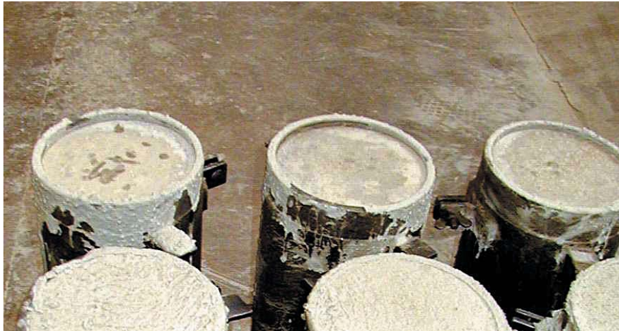
Fig. 8 - Exemple de ressuage d'éprouvettes cylindriques en béton de granulats alluvionnaires (rapport e/c de 0,70 environ).
