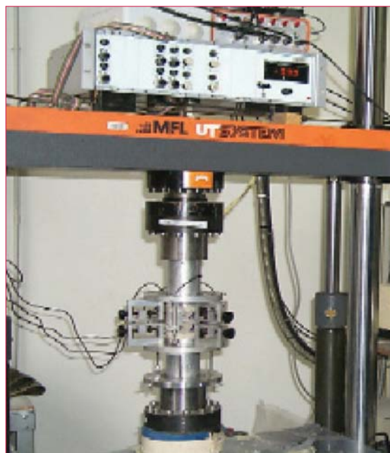
b. Ensemble : éprouvette, casque et extensomètre.
