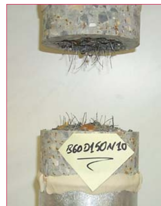
Fig. 2 - État des faciès et des fibres après séparation des deux parties de l'éprouvette.
