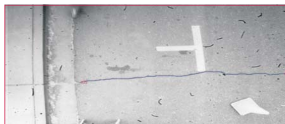
b. Extraction de la fissure ; le rectangle rouge à l'extrémité de la fissure représente la position initiale de la fenêtre d'observation.
