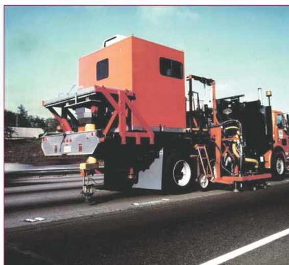
b. Prototype de conception ancienne. Le bras situé sur le flanc droit du véhicule est dédié aux fissures longitudinales alors que le bras situé à l'arrière se charge des fissures transversales.
