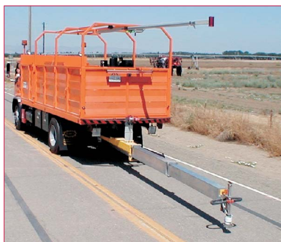
a. Prototype de Crack Sealing Machine. Le bras, composé de deux segments télescopiques, est monté sur un axe qui lui permet de pivoter sur près de 180 degrés. L'extrémité du bras supporte une brosse métallique rotative pour décaper les abords de la fissure et une buse pour y injecter le bitume. Les images issues d'une caméra CCD, fixée sur un bras déployé manuellement au-dessus de la chaussée, sont utilisées pour guider le bras.
