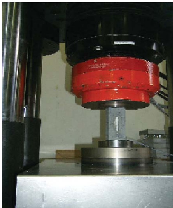
Fig. 4 - Dispositif expérimental adopté pour les essais de compression sur éprouvettes prismatiques.
