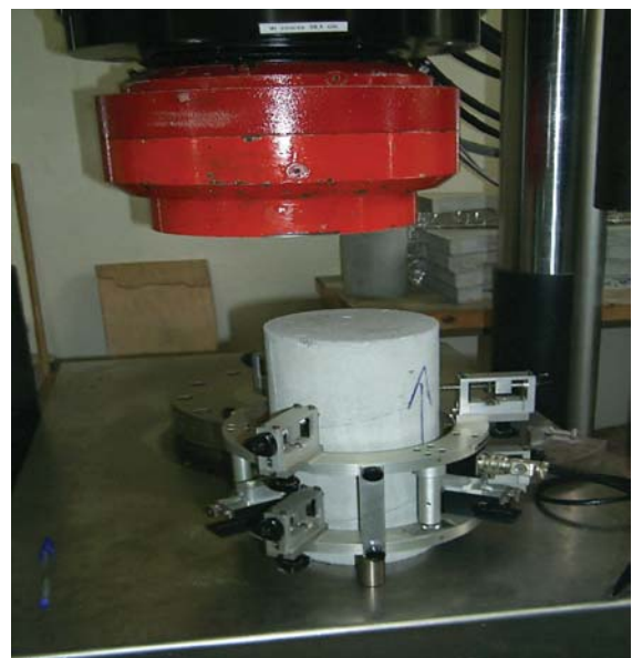
Fig. 5 - Dispositif expérimental adopté pour déterminer le module d'Young et le coefficient de Poisson sur des éprouvettes cylindriques.
