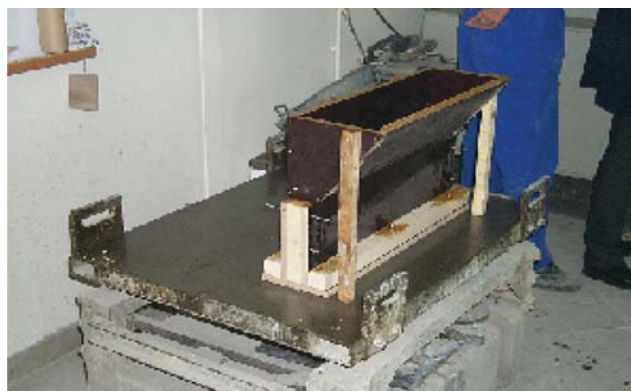
Fig. 1 - Dispositif de coulage des nervures.
