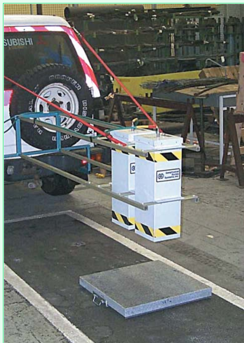
Fig. 2 - Essai sur une plaque test de granite avec l'antenne 2 GHz du LRPC d'Autun.
