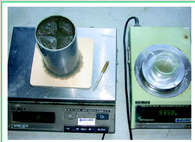
Fig. 3 - Vue générale du dispositif utilisé pour la mesure du ressuage. Le moule est posé en permanence sur une balance précise au dixième de gramme. L'eau prélevée est pesée sur une autre balance plus précise. Un cache est posé sur le moule entre chaque prélèvement.
