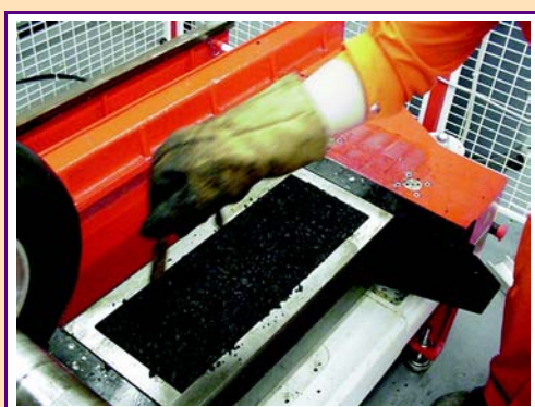
Fig. 11 - Compactage de plaques.
