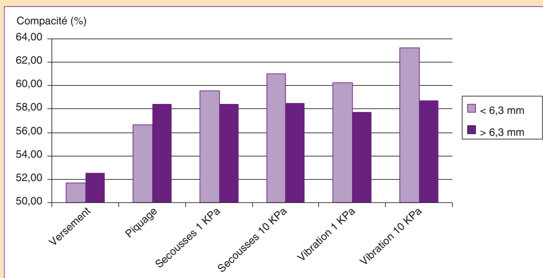
Fig. 3 - Valeurs moyennes de compacité pour tous les matériaux selon les différents modes opératoires, en distinguant les fractions fines (inférieures à 6,3 mm) et les fractions plus grossières (supérieures à 6,3 mm).
