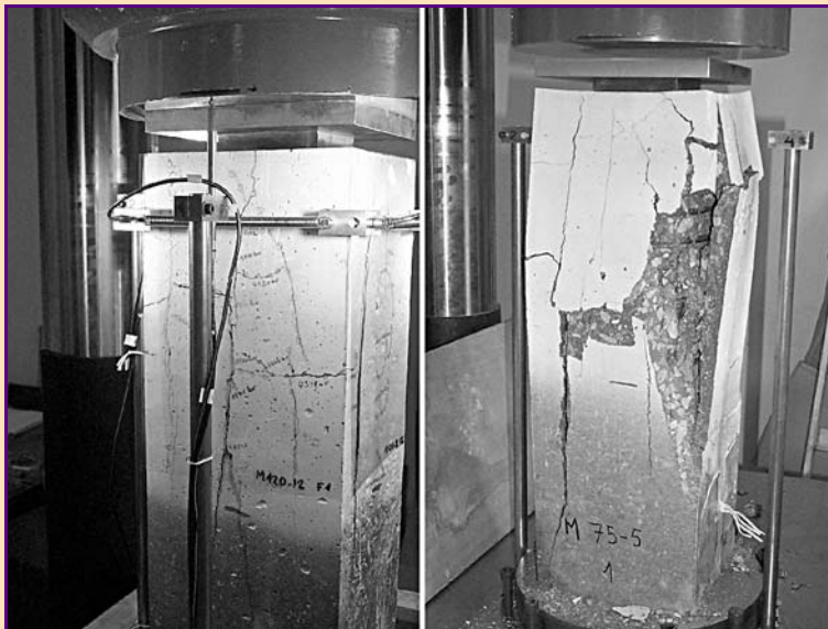
Fig. 17 - Essais de compression localisée sur prismes. Fissuration et rupture de l'enrobage.
