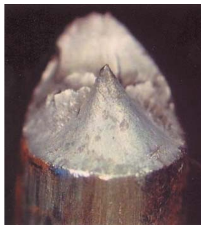
b. Rupture en « fer de lance » amorcée sur une décohésion.
