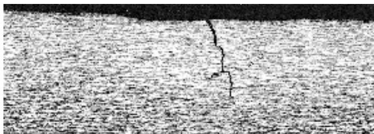
b) Fissure de fatigue.
