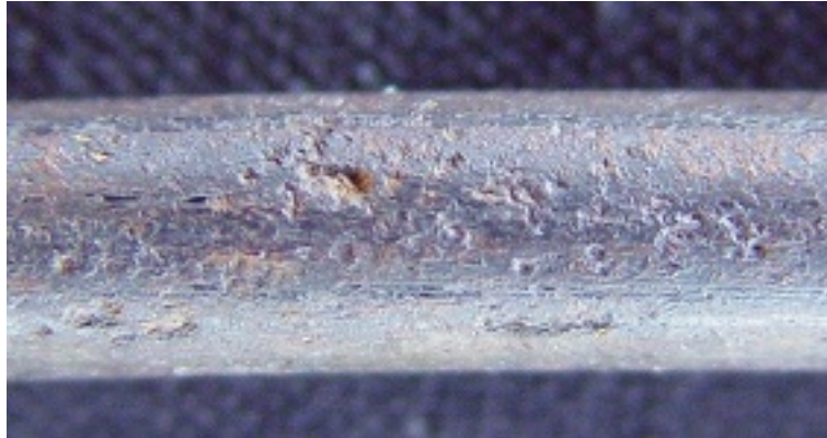
a) Acier ancien. Arrachements en surface.
