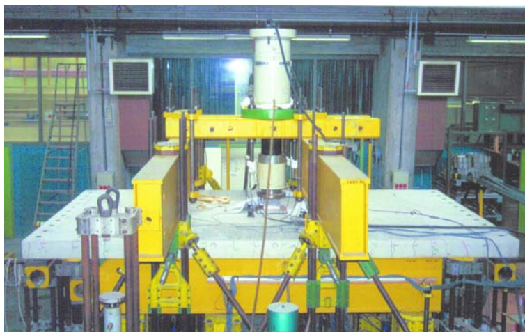
□ Figure 5 Essai de fatigue en flexion sur dalles pré-fissurées [13].
