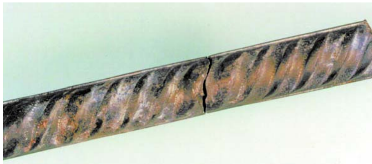
□ Figure 7 Rupture en fatigue d'un acier HA16 nu. Essai sur presse au LCPC Nantes.
