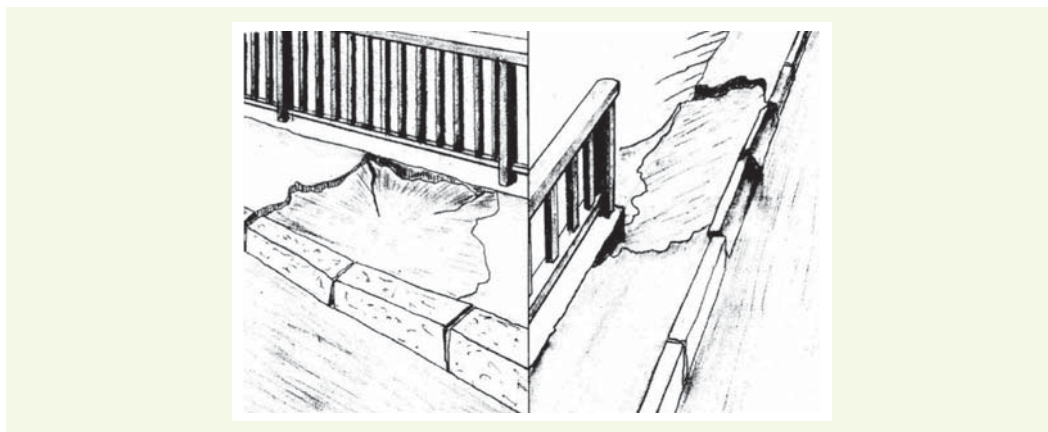
figure 2 Affaissement de trottoirs.
