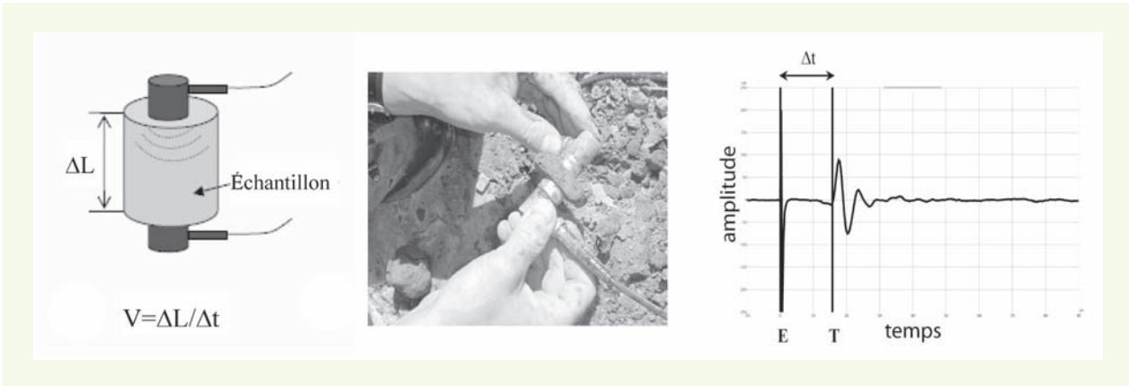
figure 6 Mesures de V_p sur échantillons de matrice : a : Schéma du dispositif. b : Photo des mesures in situ , mesure des longueurs au pied à coulisse (précision 1/10 mm). c : Visualisation du signal acoustique sur oscilloscope (précision visuelle).
