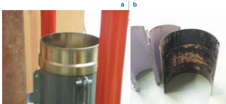
figure 13 Moule : - a : rehausse, - b : géomembrane.
