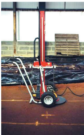
figure 11 Mesures effectuées sur le remblai : - a : double sonde, - b : pénétromètre dynamique, - c : essai de plaque.
