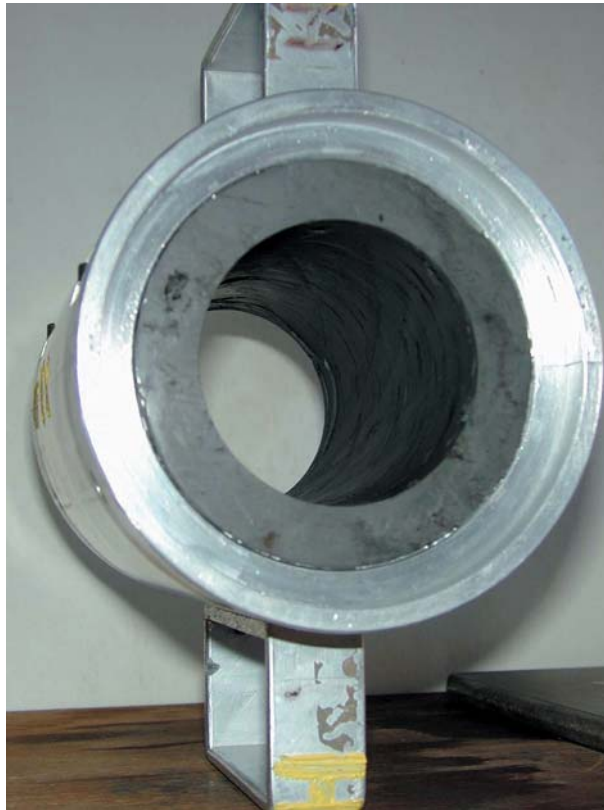
figure 13 Éprouvette de sol naturel après creusement.
