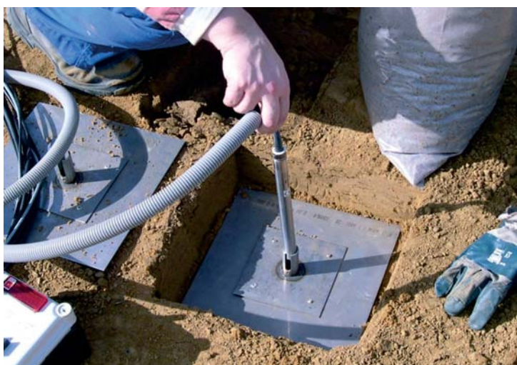
Figure 18 Capteur à câbles de déplacement horizontal a) boîtier de conditionnement b) vue après pose
