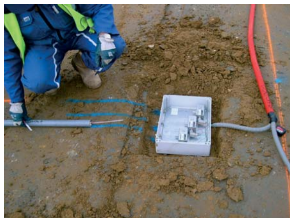
Figure 18 Capteur à câbles de déplacement horizontal a) boîtier de conditionnement b) vue après pose
