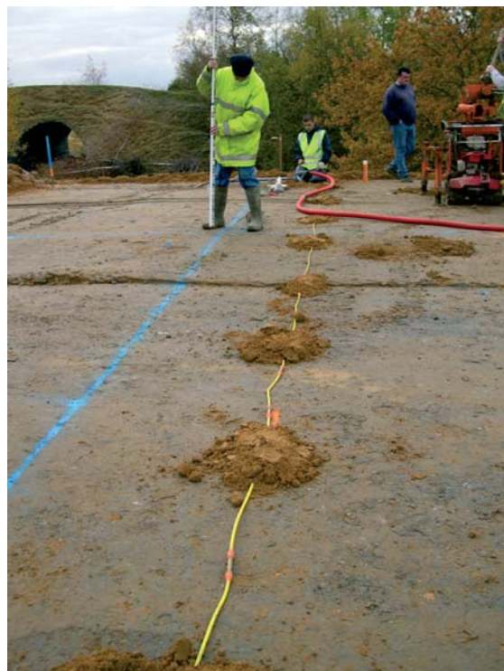
Figure 11 Flûte interne d'électrodes pour tomographie de résistivité électrique
