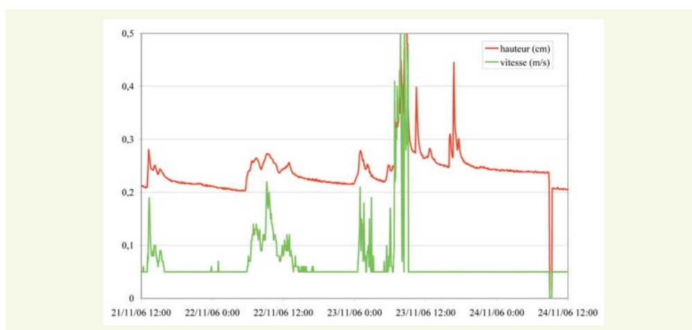
figure 7 Évolution des vitesses et des hauteurs en présence du seuil avec forme en V.
