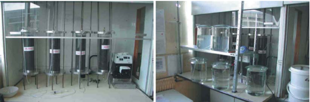
figure 3 Dispositif de percolation simulée.
