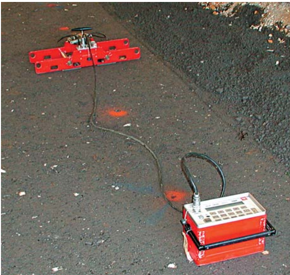
figure 7 Mesure au gammadensimètre à profondeur variable (GPV).
