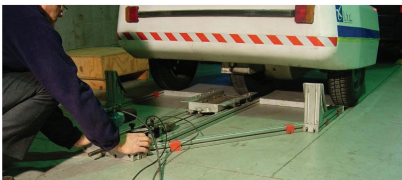
figure 4 Positionnement du banc d'étalonnage de la chaîne d'effort horizontal (Photothèque STAC).
