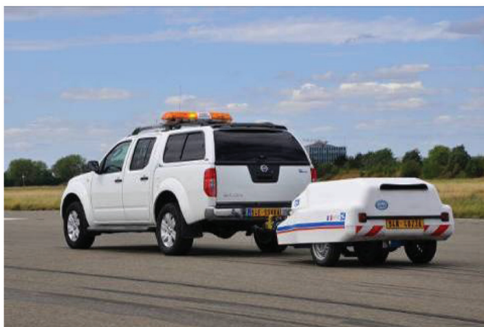
figure 2 Instrument de Mesure Automatisée de la Glissance (IMAG) du STAC (Photothèque STAC).
