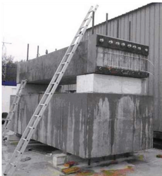
figure 3 Photo du montage de l'ensemble {poutre + bâti}.
