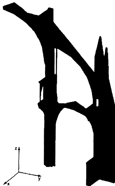
Fig. 6 - Représentation du modèle tridimensionnel de base pour l'élaboration du maillage global.
