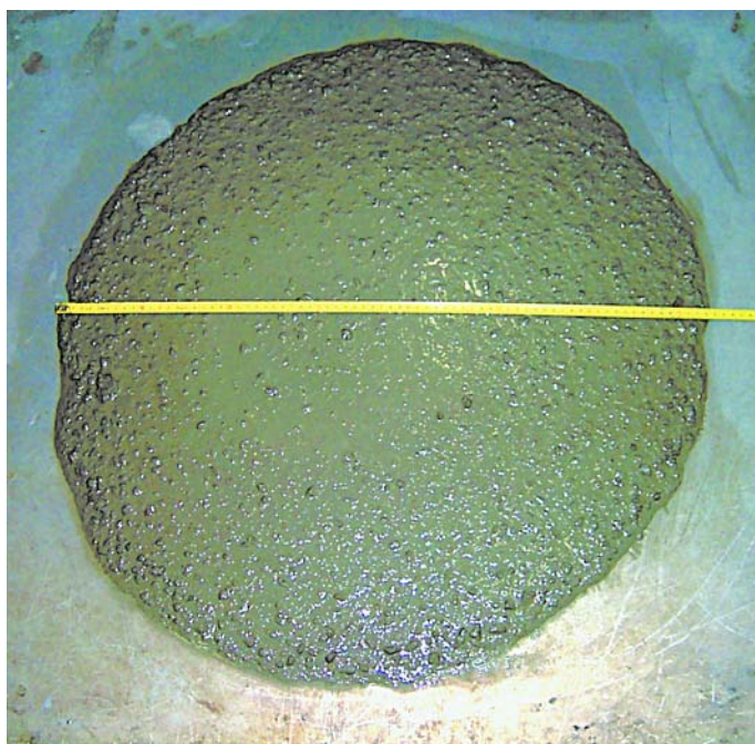
□ Figure 3 Mesure de l'étalement d'un BAP au cône d'Abrams.
